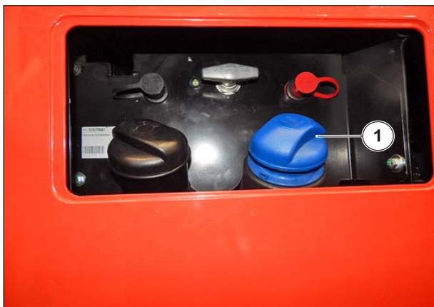
Afbeelding 122: Het reservoir voor DEF-vloeistof vullen
