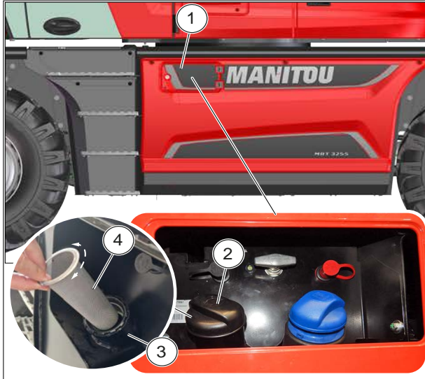
Afbeelding 225: Het filter van de brandstoftankopening controleren en reinigen
