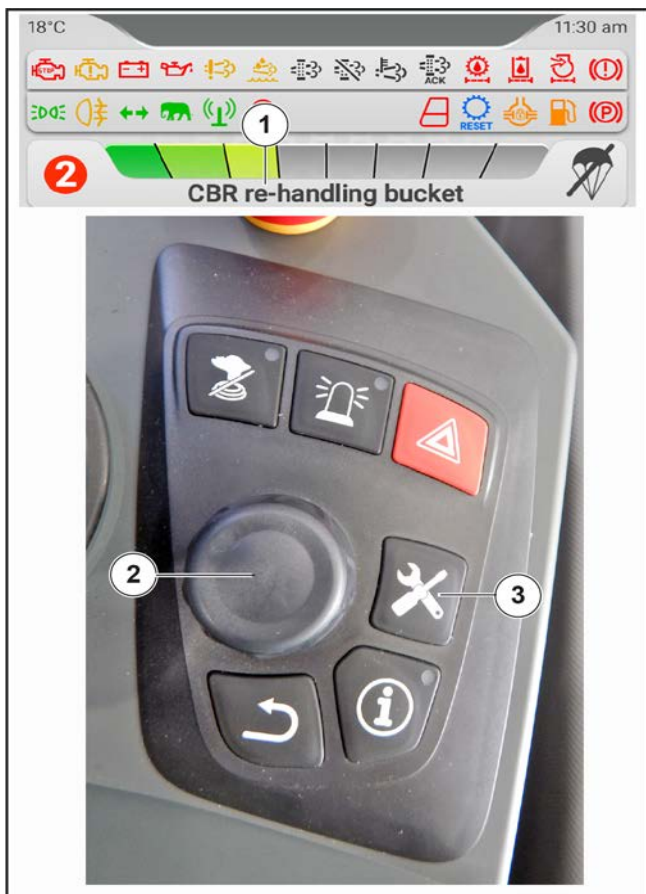
Afbeelding 125: Het hulpstuk selecteren en bevestigen
