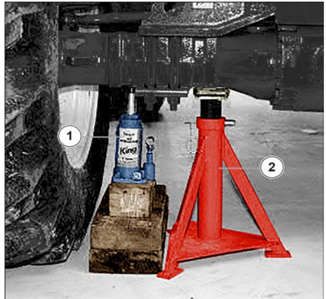
Afbeelding 212: Een wiel vervangen
