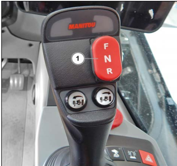
Afbeelding 132: De FNR-keuzeschakelaar gebruiken
